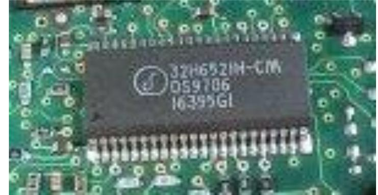
集積回路実装基板＝集積回路＋プリント基板
